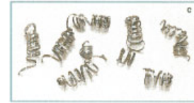
Свободно намотанная (витая) стружка - идеальные условия резания
